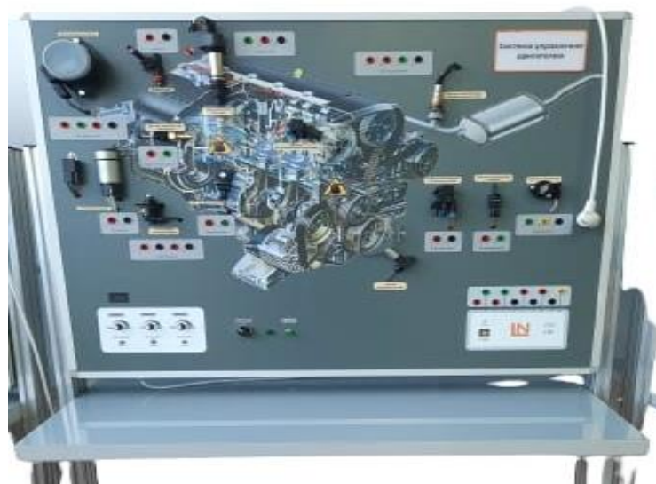
Инжекторлы қозғалтқыштың басқару жүйесі. (стенд)
